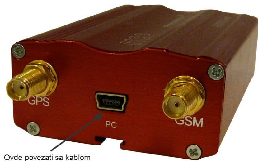
**NAPOMENA:** Ne povezujte uređaj sa računarcem koristeći USB kabl! PC port na uređaju je serijski port! Uređaj povežite isključivo serijskim kablom prikazanim na prethodnoj slici!
